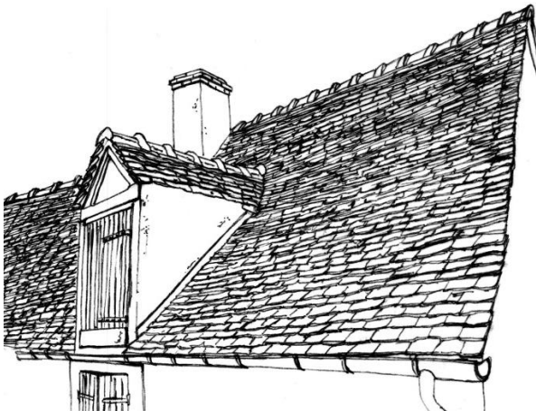
Couverture de tuiles plates.
