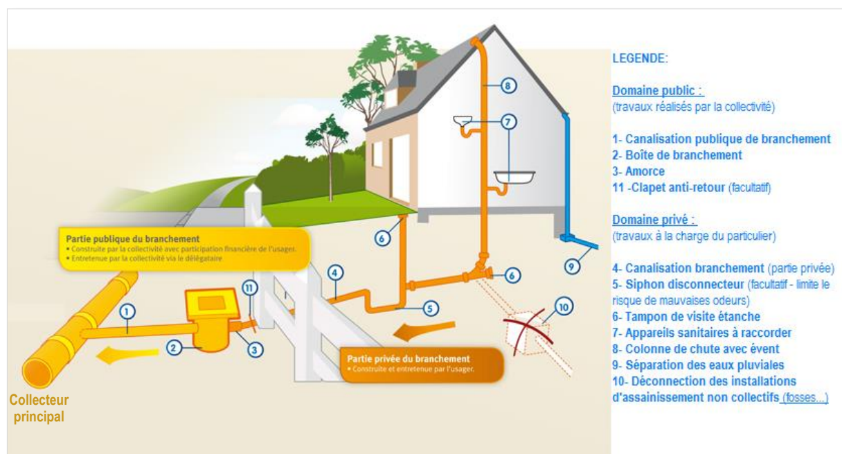
Figure 3 : Schéma de principe d'un raccordement sur système de collecte de type séparatif
