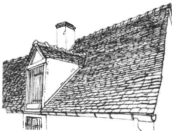
Couverture de tuiles plates.
