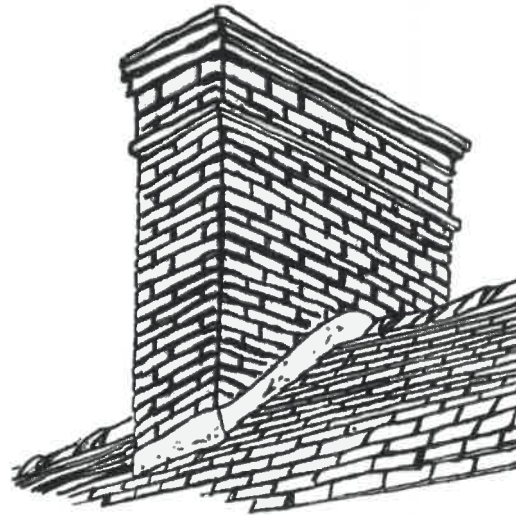
Cheminée de section rectangulaire en briques apparentes.
